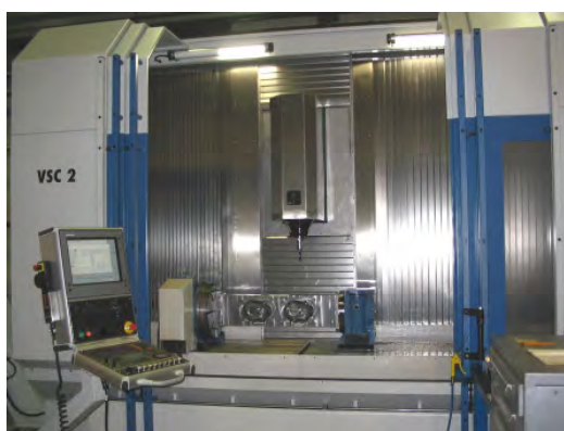
CNC+iTNC530 – прецизионная шлифовальная установка, точность \pm 0,005 мм
